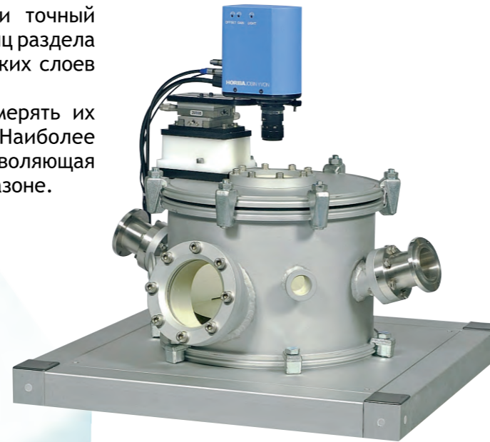
Рисунок 1. In-situ контроль технологического процесса нанесения эпитаксиальной пленки при помощи спектральной эллипсометрии.
