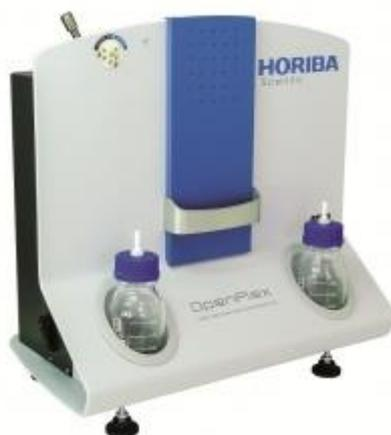
**Система OpenPlex** предназначена для изучения методом визуализации поверхностного плазмонного резонанса (Surface Plasmon Resonance Imaging) непосредственного взаимодействия биомолекул: белков, пептидов, ферментов, антител, ДНК, РНК, микроорганизмов, живых клеток, а также для анализа эффективности лекарственных средств в режиме реального времени без необходимости предварительного мечения участников реакции или введения в систему дополнительных компонентов, облегчающих детектирование.
