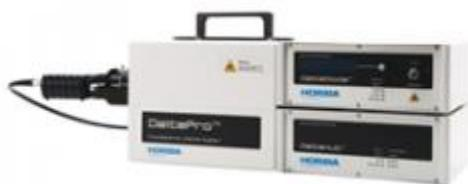
**HORIBA DeltaPro** – доступная и эффективная модульная система, основанная на фильтрах. DeltaPro является одной из самых доступных на рынке систем для проведения высокоскоростных исследований времени жизни флуоресценции с пикосекундным разрешением.
