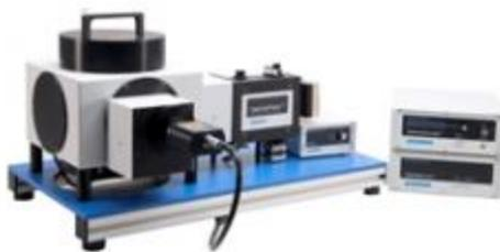
**HORIBA DeltaFlex** – гибкая и мощная модульная система исследовательского класса, предназначенная для измерения времени жизни флуоресценции. В ее основе лежит метод подсчета единичных фотонов с корреляцией по времени.
