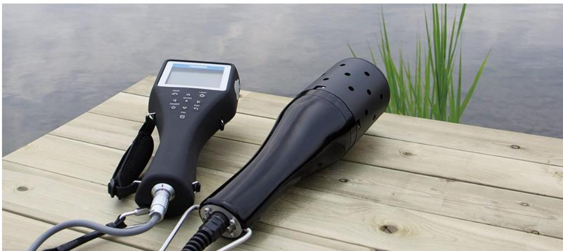
Серия портативных анализаторов U-50 позволяет одновременно измерять и отображать на дисплее до 11 параметров. Надежная конструкция и удобство в работе делает эти приборы незаменимыми при полевых измерениях, таких как мониторинг рек, дренажных каналов, грунтовой воды и т.п.
