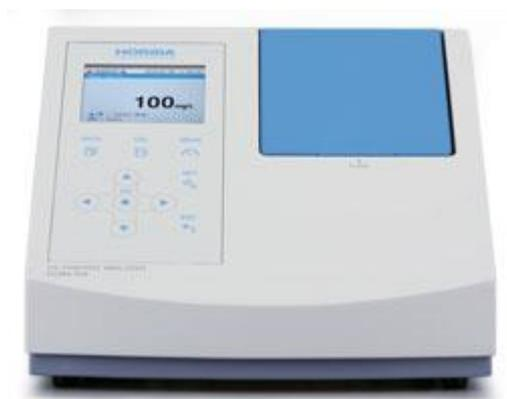
ОСМА-550 для измерения следовых концентраций нефтепродуктов, а также измерений концентраций нефтепродуктов, прилипших к твердым веществам, таким как почва. Измерение можно легко провести, лишь поместив экстракт в прилагаемую ячейку, и установив ячейку в оборудование.
