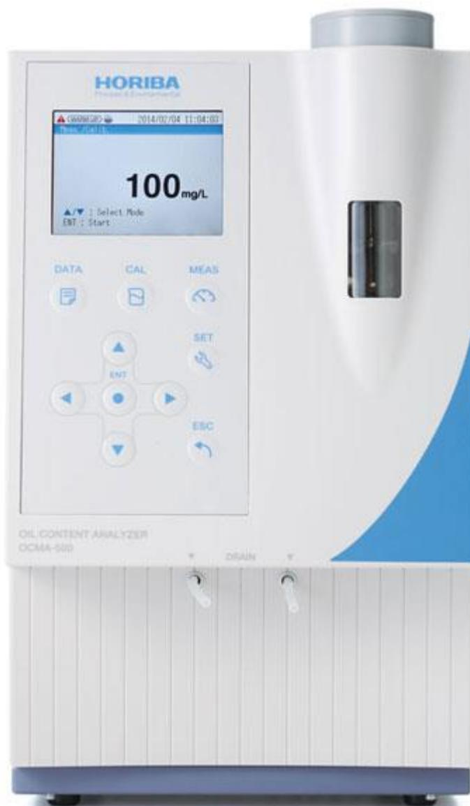
Анализатор ОСМА-500 предназначен для измерения концентрации нефтепродуктов, содержащихся в различных типах вод. Анализатор снабжен встроенным экстрактором и позволяет работать в полностью автоматическом, полуавтоматическом и ручном режимах.
